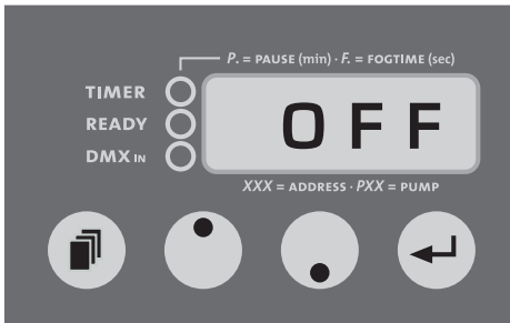
Abb. 4: Display-Anzeige beim Ausschalten des Gerätes
